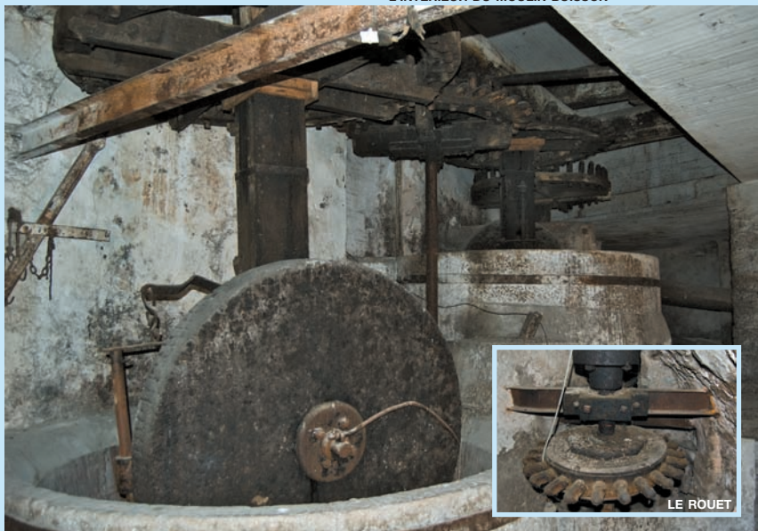
UN SYSTÈME DE TRANSMISSION PAR ROUES DENTÉES ACTIONNE LA MEULE DU MOULIN BUISSON
